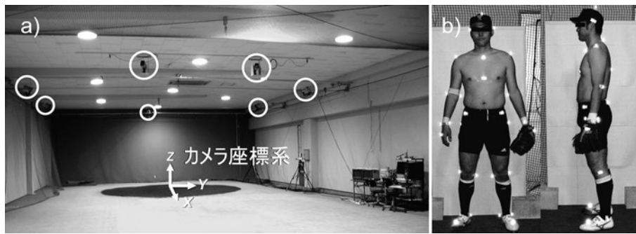
図1 投球動作計測システムと反射マーカ貼付位置 a) 投球動作計測システム, b) 反射マーカ貼付位置
