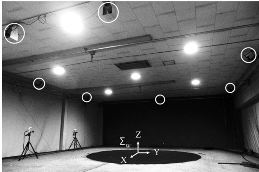
図3 投球動作計測システムとカメラ座標系  $\Sigma_w$
